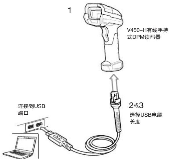
注：此连接方案还用于将V450-H手持式读码器连接到欧姆龙NA系列控制器。
