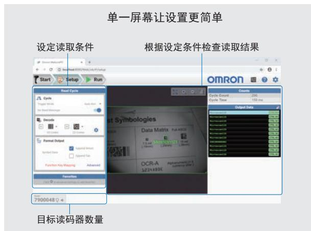
使用PC设置工具WebLinkPC轻松设置。可以在单个屏幕上设置常用的读取条件并检查读取结果，从而提供高效的设置。
